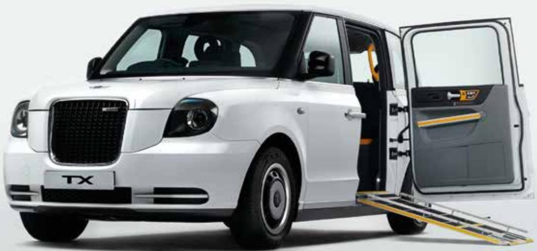
nomie à essence de 1,5 litre (60 kW) fournit assez d'énergie pour maintenir l'état de charge de la batterie et porter son autonomie jusqu'à 510 km et tout en limitant les émissions à 19g de CO<sub>2</sub>/km.
